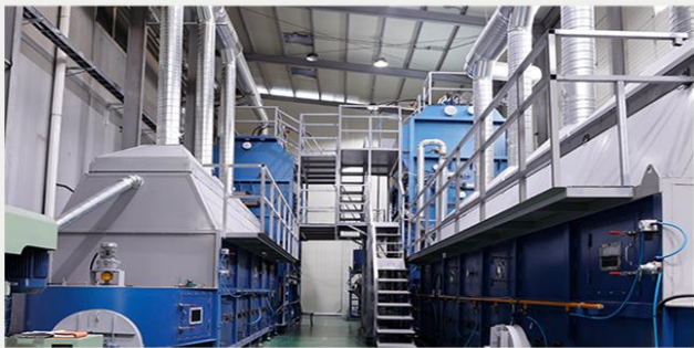
난연액 코팅기 완전 자동화 설치
