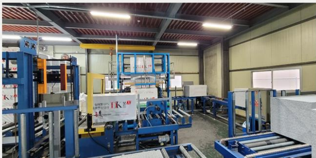
난연액 코팅기 완전 자동화 설치
